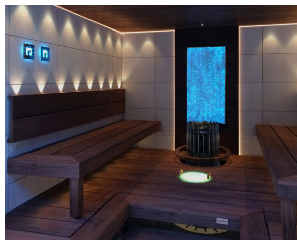
Ljusfiberbelysning monterad i tak. Projektorn kan monteras på vägg under bastulaven eller utanför bastun.
