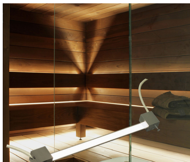
Sauna Linear LED 2 m. 2x1 W. IP55. Installeras bakom ryggstöd eller under bastulaven, max höjd från golv 1.5 m. 2.0 m anodiserad aluminium som kan kapas. Max monteringshöjd för installationsboxen 0.8 m. Levereras med kabellängd 2.5 m
