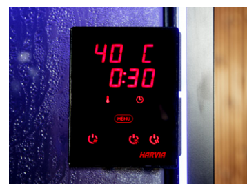
Med styrpanelen styr man värmen i kabin mellan 30 - 50 grader.
