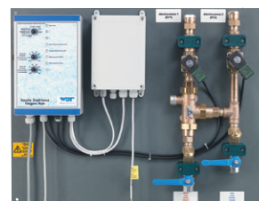
Niagara Rain SED1-2K Tre program, Tropical Rain, Fog Shower och Niagara Rain. Programmen innehåller både ljus och ljud. Teknikplatta bxhxd 500x650x200 mm.
