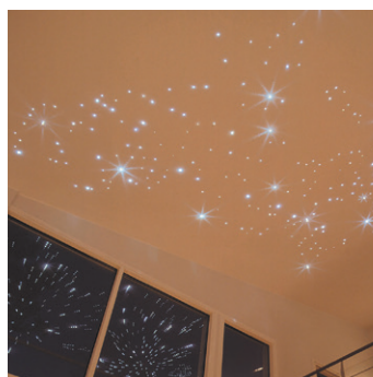
Stjärnorna placerade osymmetriskt, montera flera fiber tillsammans för en starkare stjärna.
