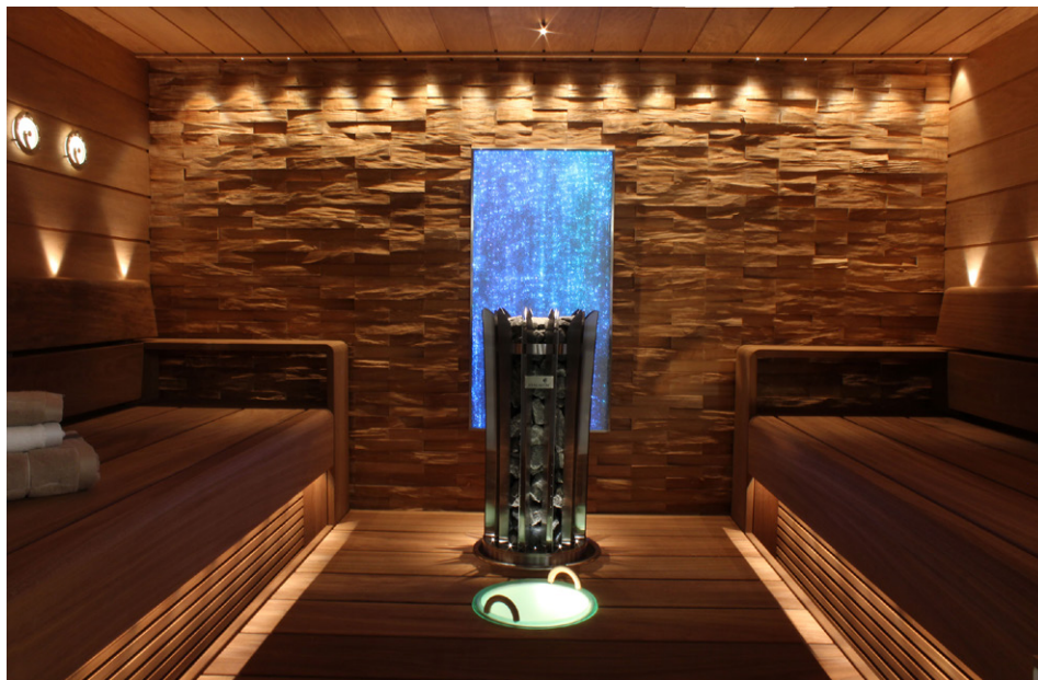
Ljusfiberbelysning Sauna Seat, placerad bakom ryggstöd och i bastulavens framkant. Projektor monterad under bastulaven. Till tak används t.ex. någon av de färdiga bastupaketen, projektorn kan då placeras utanför bastun.
