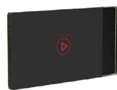
Höjer temperaturen med 30° C i 20 minuter för att erhålla en högre temperatur vid t.ex. en Aufgussceremoni och för att spara energi när bastun inte används.
