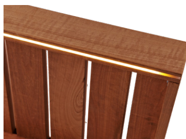
Med ett urfräst spår (6x12 mm) monteras ljuslisten snyggt och enkelt.
