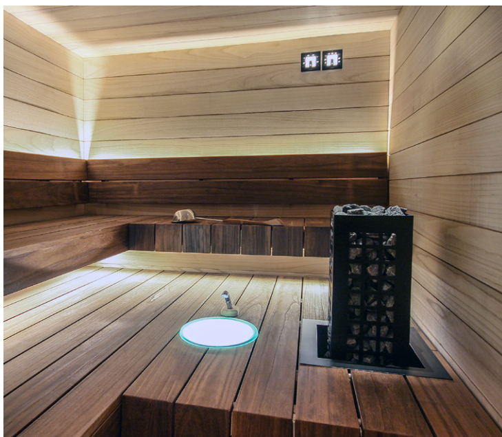
Pro Nordic bastuinteriör i 155 mm värmebehandlad Empress, panel på väggar i Empress. LED-belysning bakom ryggstöd och under bastulaven. Integrerat bastuaggregat och ljusfiberbelyst vattenskål.
